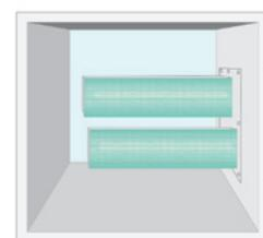
Типичный вид установки внутри вентиляционного канала
